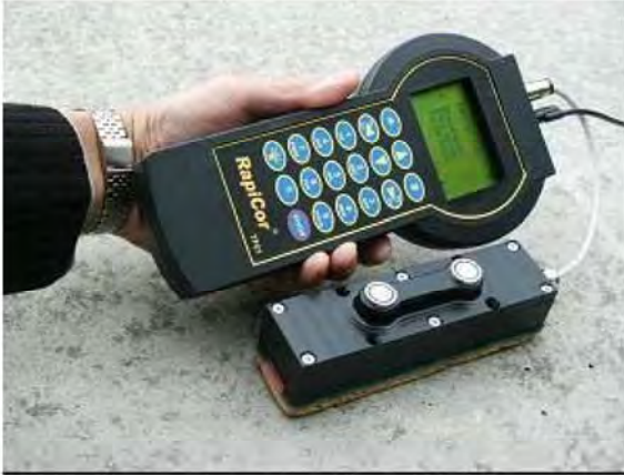
Uppmätning av kloridhalten vid armeringsjärnen
