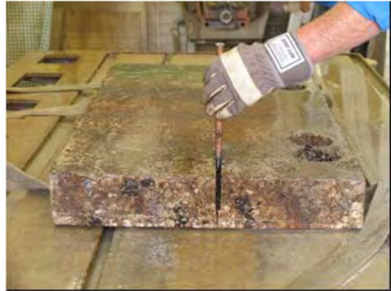
Uppmätning av kloridhalten vid armeringsjärnen
