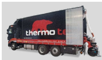
Levering, blanding og udpumpning direkte fra thermotec® Mixmobil(blandebil)
