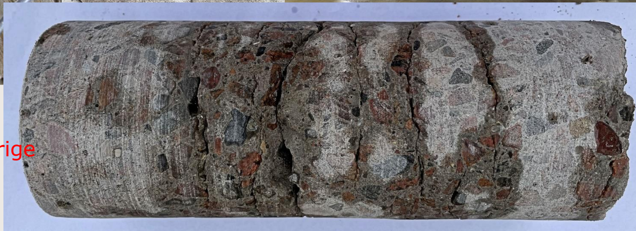
En borekerne lige efter udboring, ca. 250 mm lang
