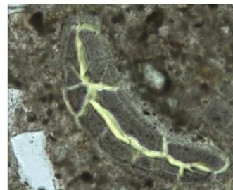
Figur 4. Mikrosilica kan have tendens til at klumpe, og det kan kræve en langvarig blanding af betonen for at få splittet klumperne ud. Billedet viser en i hærdnet beton
