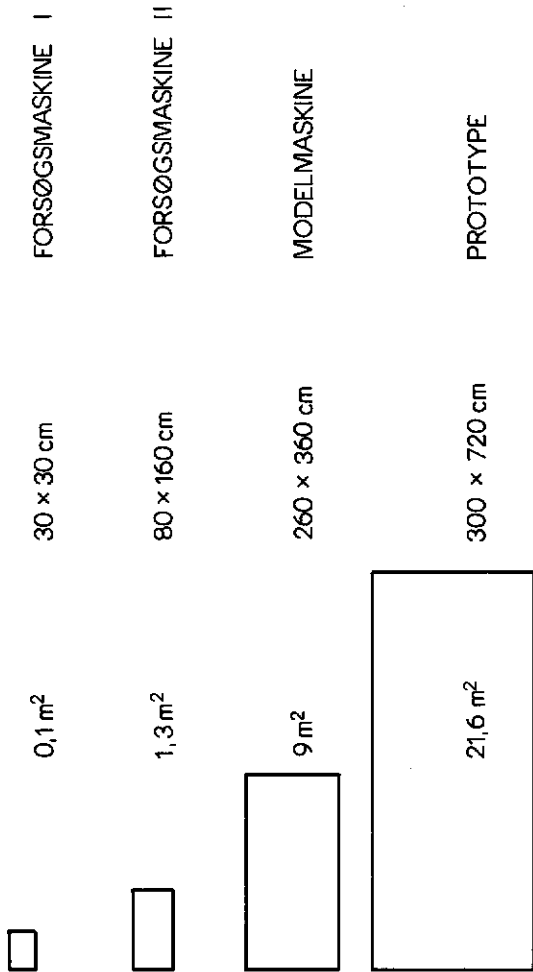
Fig. 3: Opbygning af Vipres maskiner. Forsøgsmaskine I er fremstillet i 1973 og prototype i 1978.
