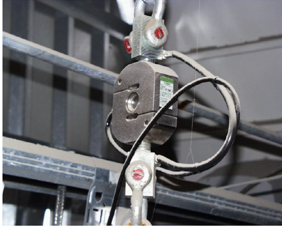
Figur 9. Vejecelle i betonproduktionsanlæg. Vejebeholderen hænger i en kæde under vejecellen. Ledningen sender signal til processtyringen.
