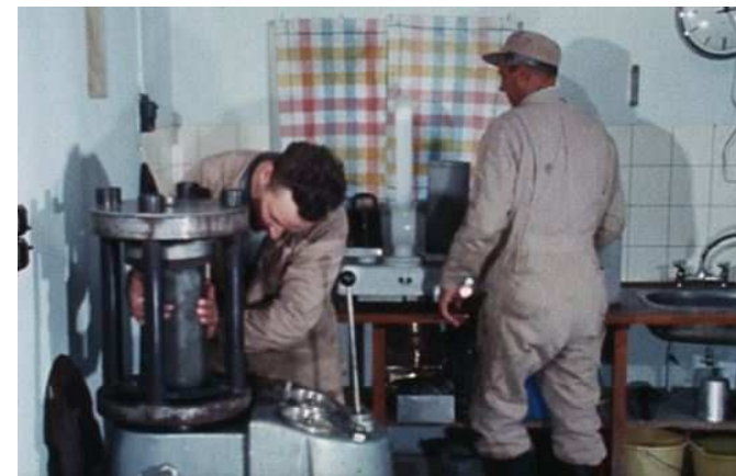
Trykprøvning af betonstyrke
